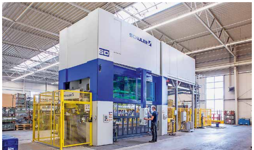
Mit Blick auf ein Projekt mit einem großen Automobilzulieferer investierte die WKF-GmbH Metallwarenfabrik in eine neue Servopresse MSD-630 mit 6.300 kN Presskraft von Schuler.
